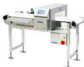
Конвейерный туннельный детектор металлов для готовой продукции
