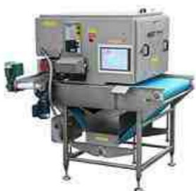
Оптический конвейерный сортировщик с CCD-камерами и лазерными детекторами
